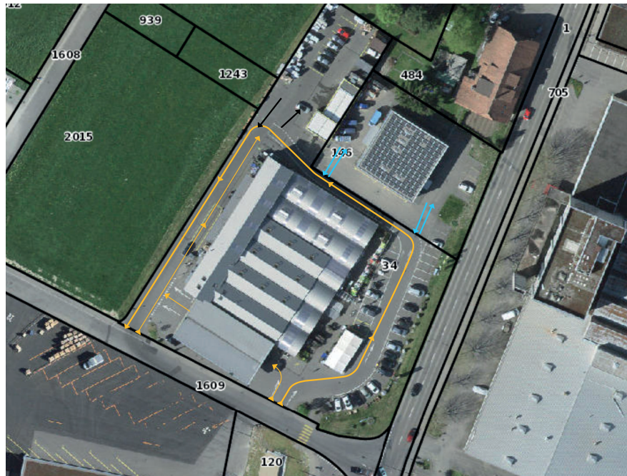
Abb. 1 Heutige Erschliessungssituation; in gelb Erschliessung Landi, in blau abgehende Erschliessung der Niklaus Sanitär AG, in Schwarz die Erschliessung der Waschanlage.
