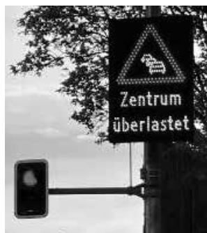
Die Dosieranlage wird den Verkehr am Ortseingang aufhalten, wenn sich die Fahrzeuge im Ortszentrum stauen (Bild: R. Beyeler)
