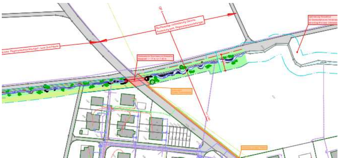
Abbildung 4: HWS Projekt angrenzend der Zuzwilstrasse. Östlich wird neu ein Trottoir gebaut, westlich wird direkt angrenzend an die Strasse wieder Boden angelegt.
