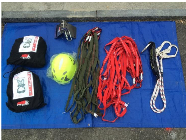
Neues Material: Absturzsicherung. Den Arbeiten in der Höhe wird heute eine grosse Beachtung geschenkt.
